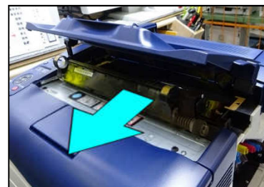
2. 背面カバーと上面カバーを開け、上面カバー部から中間転写ベルトユニットを取り出す。
