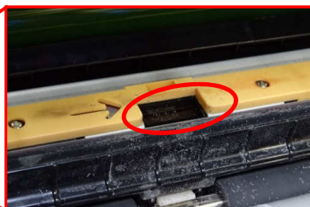
3. 背面底部に横長の黄色いパネルが見え、そのパネルに「→」マークが有り、その矢印が示す部分が画像濃度センサーです。その部分に付着した汚れや異物を柔らかい布などで拭き取ってください。
